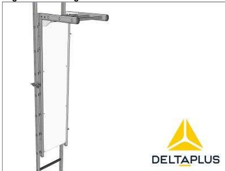
Figuur 3: Tekening afsluitbare deur kooiladder.
