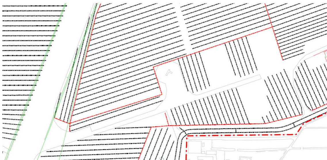
Afbeelding 2 Drainage systeem rond voormalige brandweeroefenplaats
