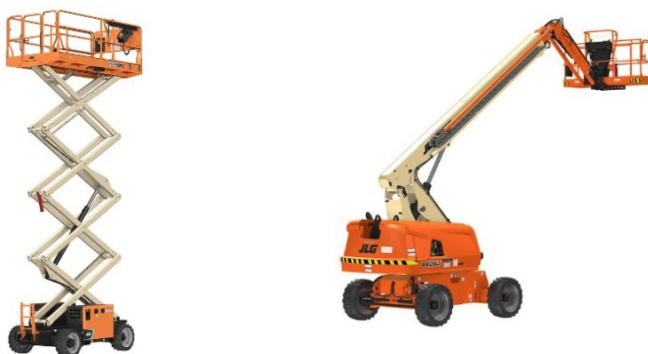
Afbeelding: Schaarlift en knikarm-hoogwerker (Bron Internet)
