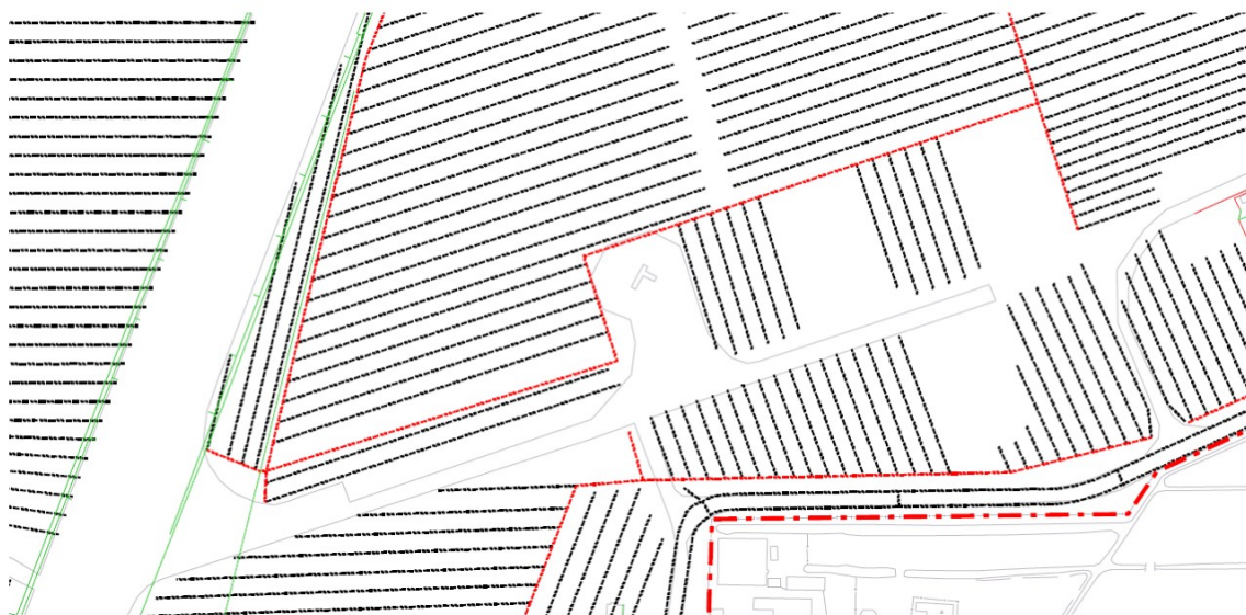
Afbeelding 2.2 Drainage systeem rond voormalige brandweeroefenplaats
