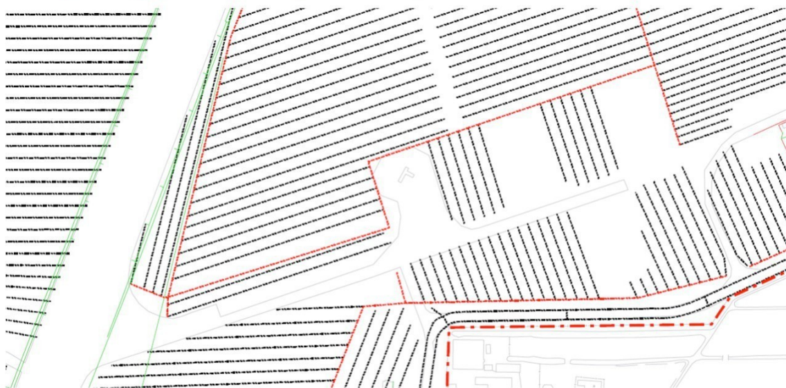
Afbeelding 2.2 Drainage systeem rond voormalige brandweeroefenplaats
